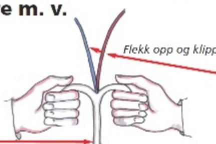
B Flekk opp den ytre kappe og klipp av de to halvdelene. Husk at den ytre kappen skal rekke litt innenfor strekkavlastningen.
