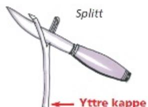
A Med en kniv skjæres forsiktig et snitt på et par cm i den ytre kappen mellom lederne uten å skade isolasjonen av disse.
